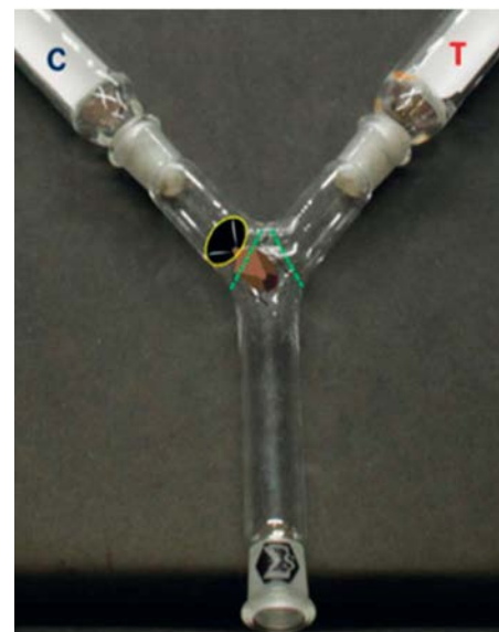
Foto 2 Olfattometro a Y: l'insetto sceglie tra la sostanza repellente testata (T) e il controllo (C), indicando l'attrazione o la repellenza
