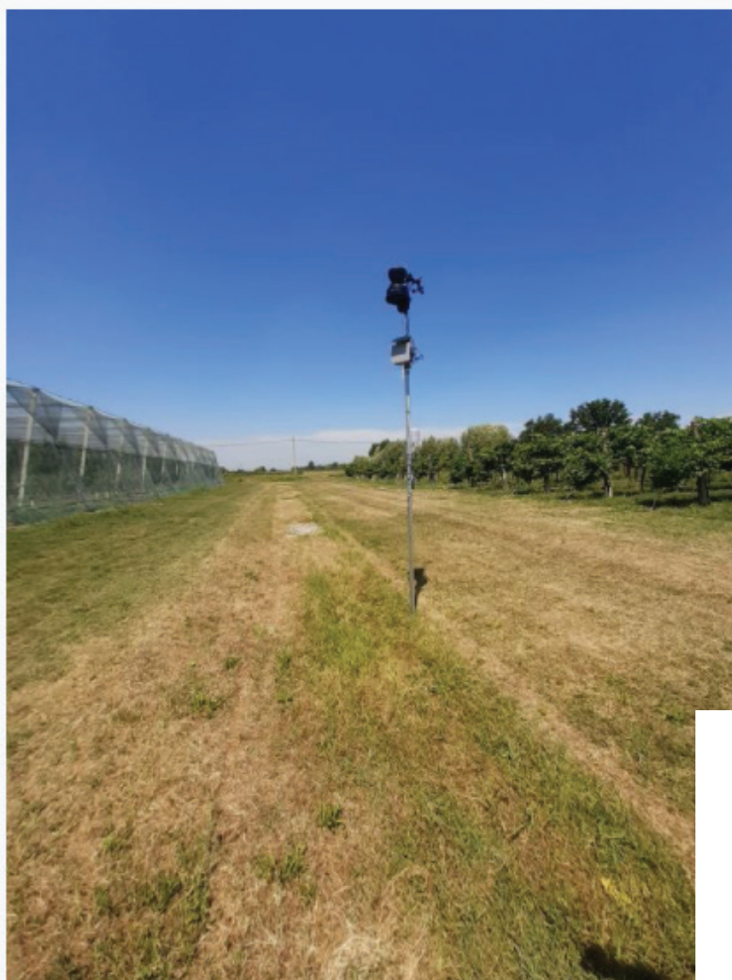
Centralina meteo per raccolta dati
