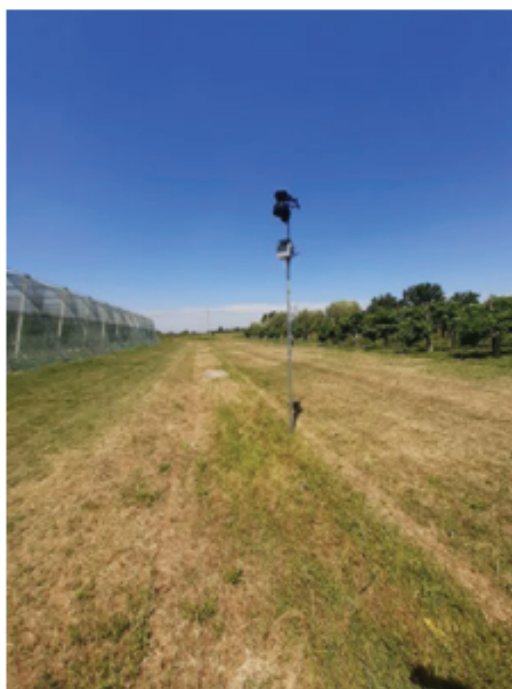
Centralina meteo per raccolta dati
