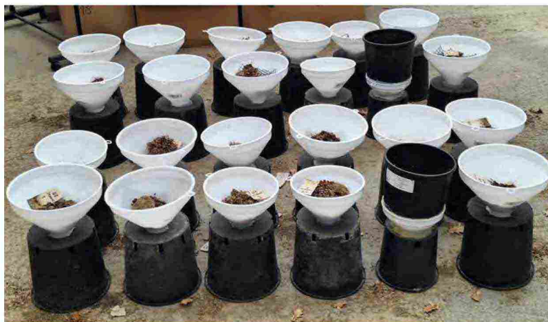
Foto 2 Imbuti di Berlese in batteria per la raccolta delle larve di elateridi dai vasetti esca prelevati dal campo (foto M. Menestrina, ASTRA)
