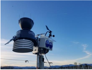
Figura 1. Wcam2 è un'innovativa fotocamera per monitorare lo sviluppo vegetativo delle colture agricole e può essere combinata ai sensori per rilevare diversi parametri agrometeorologici
